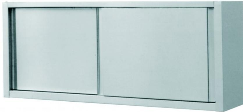
**Edelstahl-Wandhängeschrank für den Einsatz in gewerblichen Küchen, Eislaboren etc. in verschweißter Ausführung aus hochwertigem Edelstahl CNS 1.4301 (AISI304). 3-seitig geschlossen, mit doppelwandiger Schiebetür und angekanteter Griffleisten. Mit höhenverstellbaren Zwischenboden. Montagewinkel zum Aufhängen an die Wand sind im Lieferumfang enthalten.**
