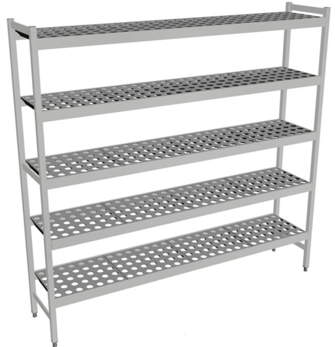
**Lebensmittelgeeignetes Regalsystem mit Aluminium-Ständern und Auflagen in Kunststoff speziell für Kühlräume und Kühlzellen (geeignet bis zu Temperaturen von -30°C). Die einzelnen Segmente der Kunststoffauflagen lassen sich jederzeit entnehmen und können in der Spülmaschine gereinigt werden. Die maximale Feldlast beträgt 600kg, die Fachlast 175kg.**
